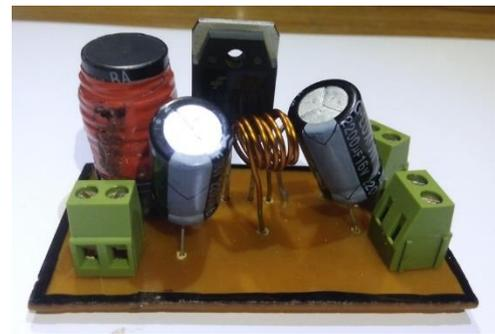
Fig. 18. Buck-Boost converter
